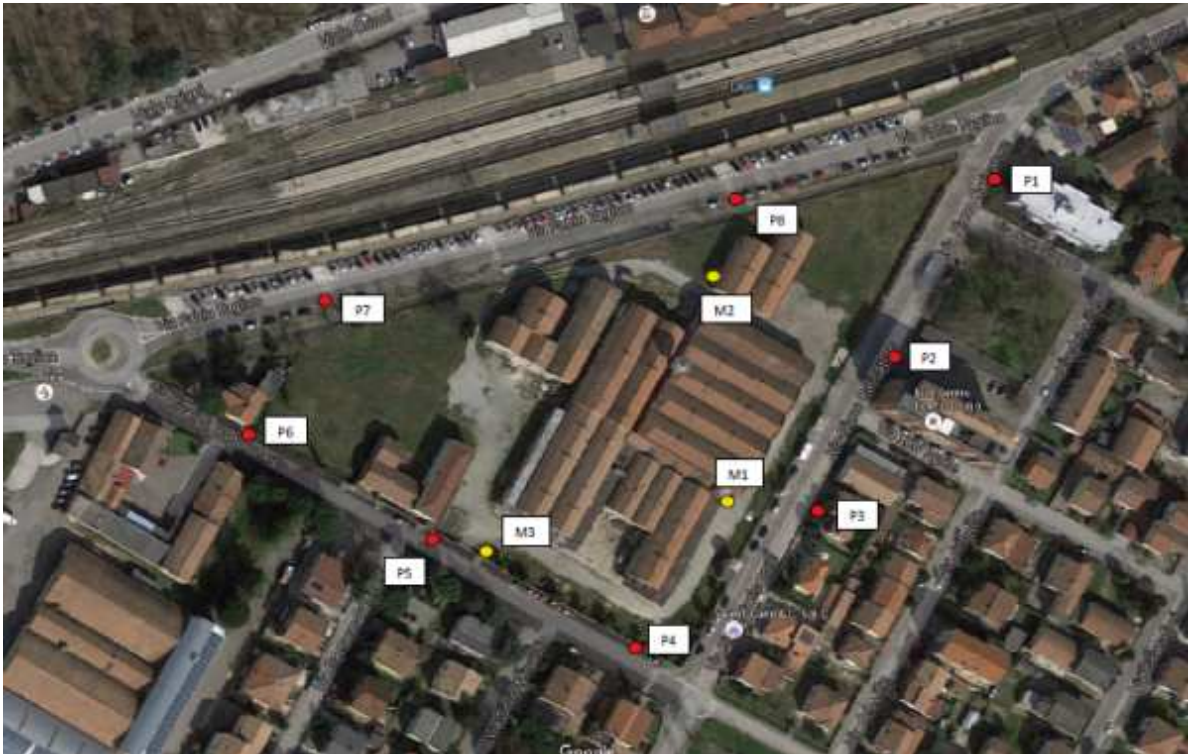
Localizzazione delle postazioni di rilievo fonometrico :i punti M1, M2, M3 indicano le stazioni di monitoraggio; P1 – P8 le stazioni di acquisizione spot.
