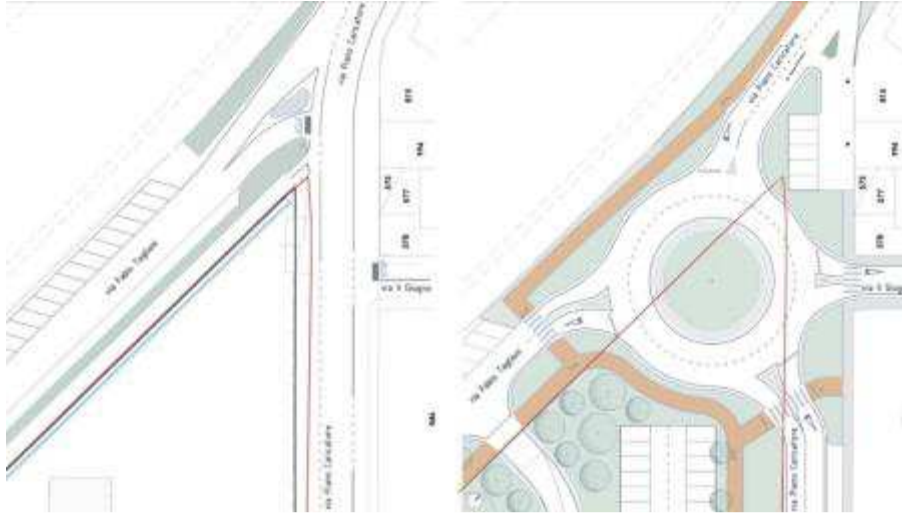
Planimetria incrocio via Taglioni e via Piano Caricatore e nuova rotatoria: stato di fatto – stato di progetto
