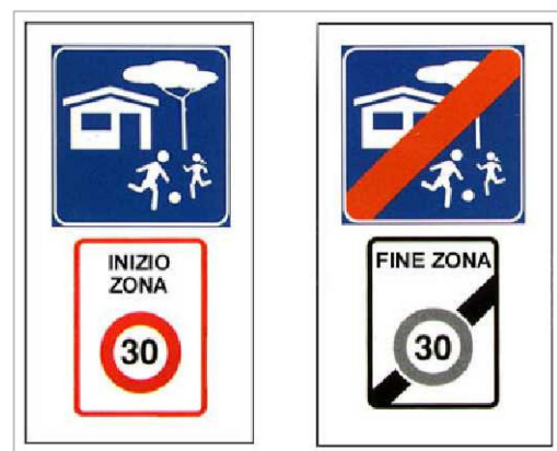
Figura 8.1.14– Segnaletica di Ingresso/Uscita di una Zona 30
