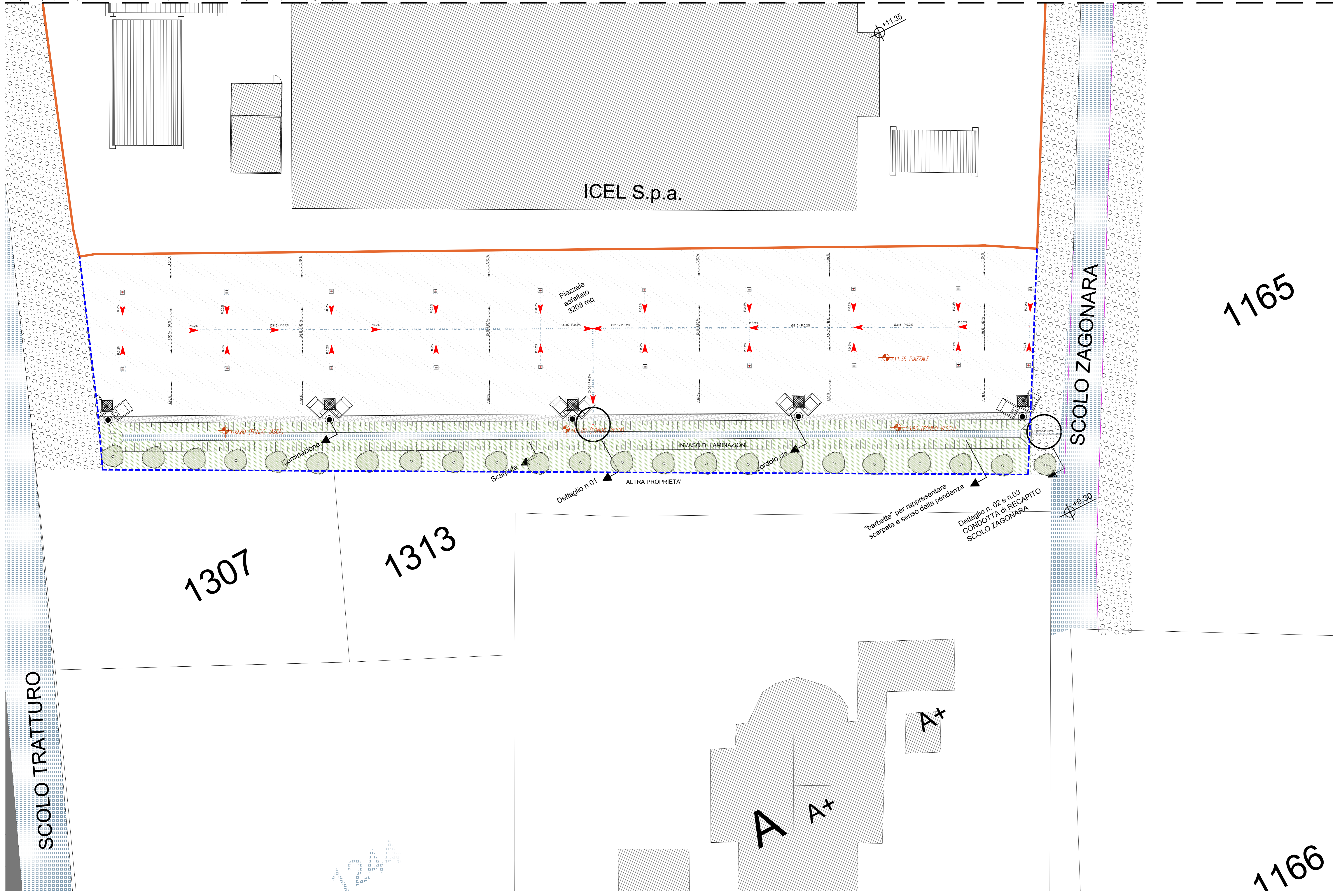
Dettaglio n. 1 (recapito rete piazzale nella vasca di laminazione) scala 1:100
